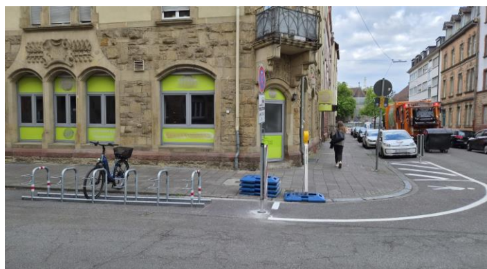
Abbildung 14 Freihalten von Sichtfeldern an Knotenpunkten
