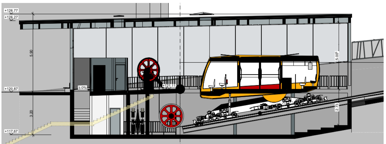
Abb. 10: Schnitt geplante Talstation mit ebenerdigen Ein-/Ausstieg
