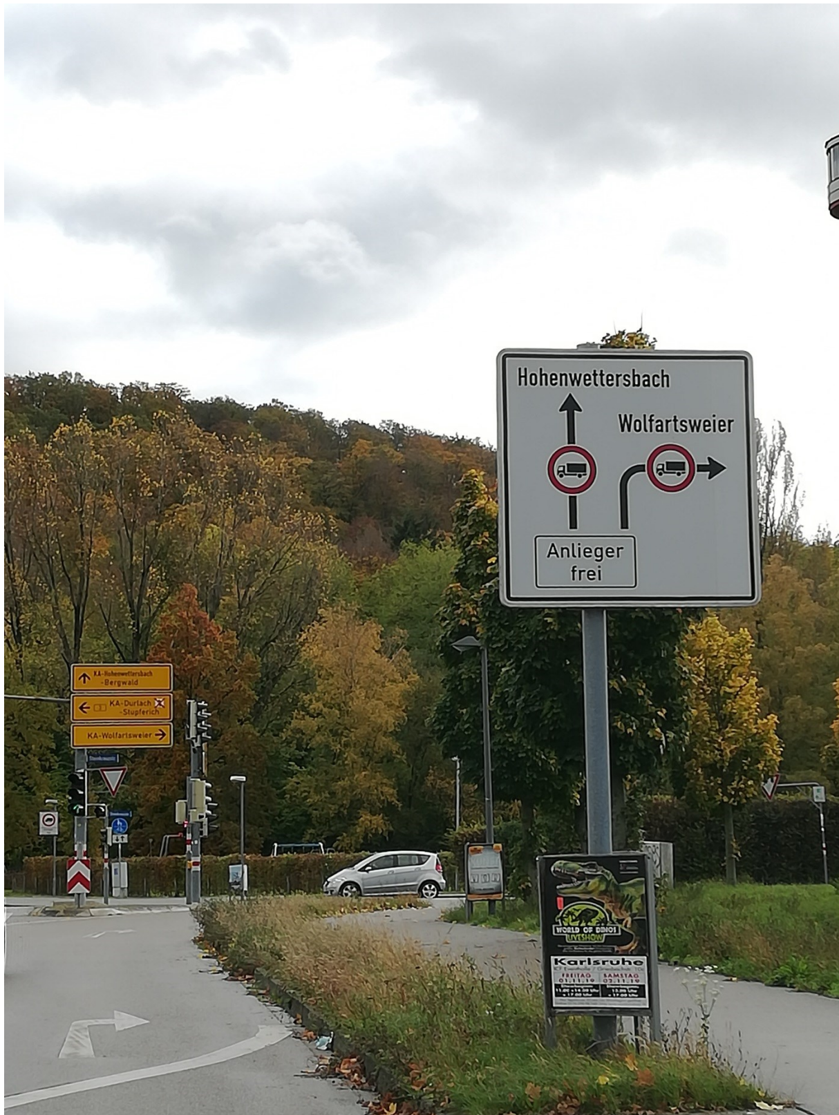
Abbildung 1: Omnibusse können die Schilder überdecken - es fehlt ein Hinweis auf fehlende Wendemöglichkeit und Höhenbegrenzung
